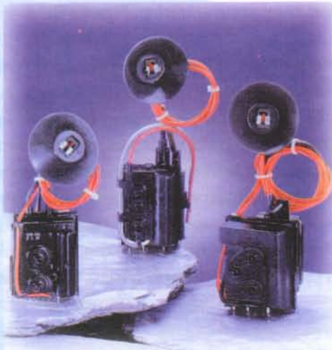
Figura 8.17. Transformadores elevadores de voltaje
